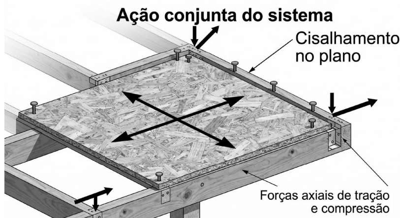
FIGURA 27. TENSÕES DE CISALHAMENTO NO PLANO DO DIAFRAGMA
